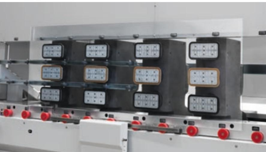
Sistema patentado de 4 carros con 3 ventosas por carro completamente independientes que garantizan una flexibilidad, una productividad y una calidad máximas gracias a una retención por vacío optimizada en toda la superficie que se procesa.
