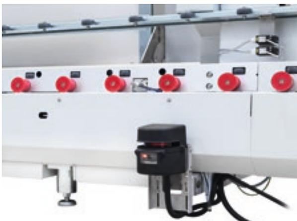
Escáner láser de la zona de carga y descarga.
